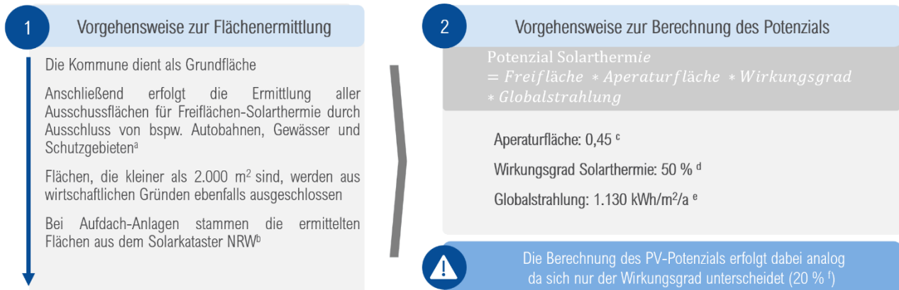
Abbildung 22: Vorgehensweise zur Ermittlung von Solarpotenzialen.
