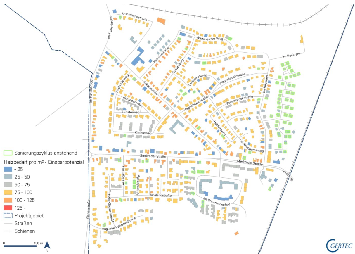
Abbildung 2: Gebäude vor dem 1. Sanierungszyklus – Teilbereich Heide
