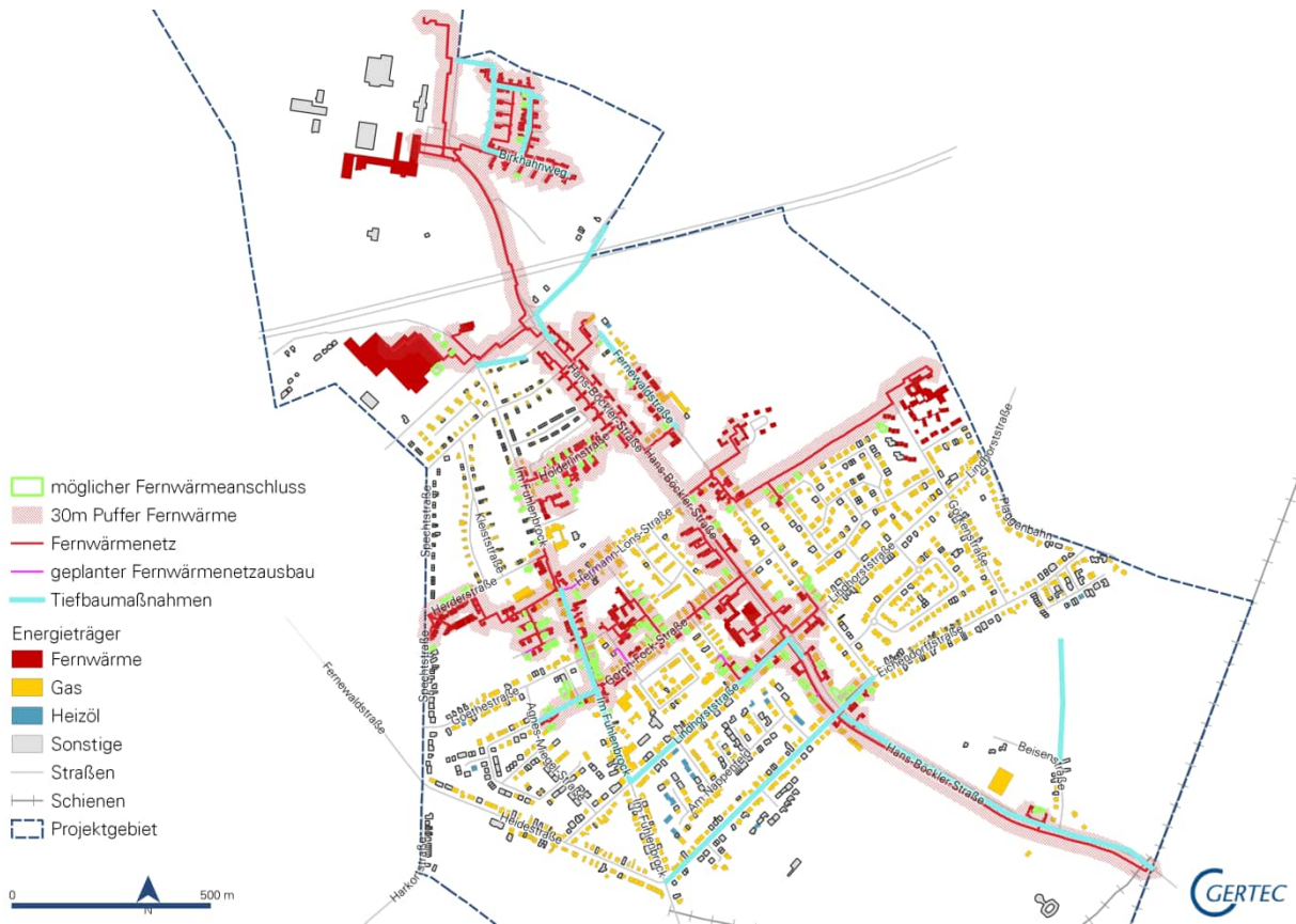
Abbildung 1: Fernwärmenetz, Tiefbaumaßnahmen Gebäude mit potenziellen Anschlussgebäuden – Teilraum Wald
