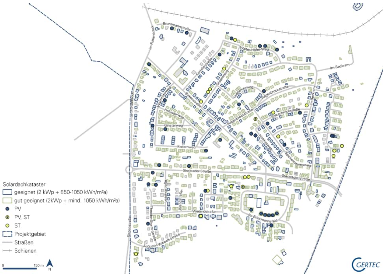
Abbildung 63: Installierte PV-, Solarthermieanlagen und Dachflächenpotenzial – Teilraum Heide (eigene Darstellung)
