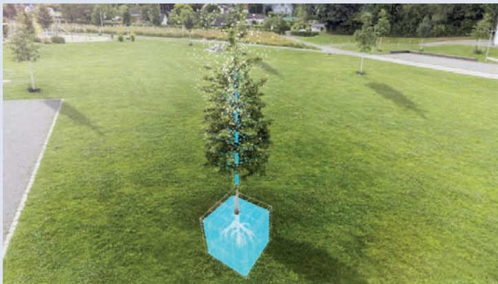
Abbildung 10: Infografik Baumrigole auf einer Freifläche (EGLV 2025)
