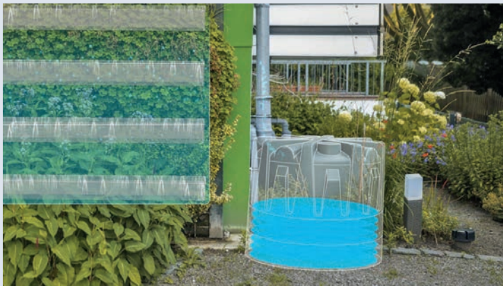
Abbildung 13: Infografik Fassadenbegrünung mit oberirdischem Wassertank (EGLV 2025)
