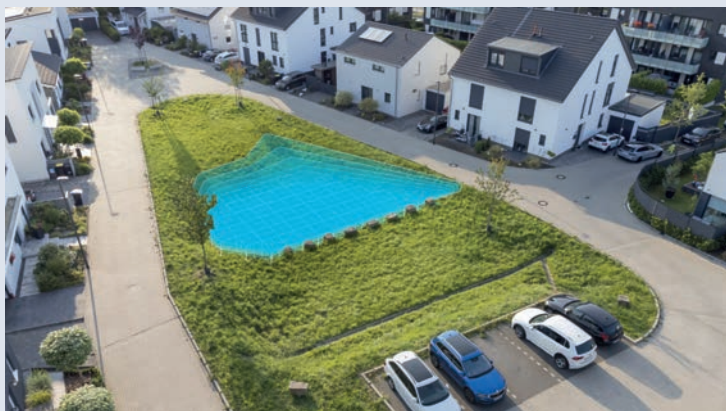
Abbildung 8: Infografik Mulden-Rigolenversickerung in einem Wohngebiet (EGLV 2025)
