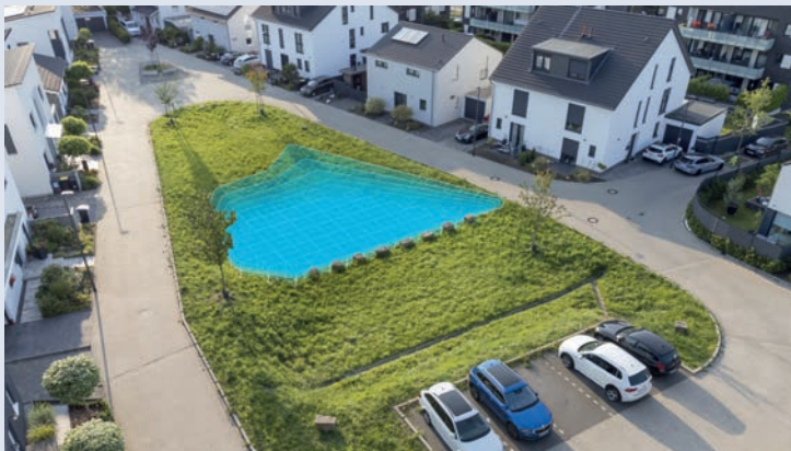
Abbildung 8: Infografik Mulden-Rigolenversickerung in einem Wohngebiet (EGLV 2025)
