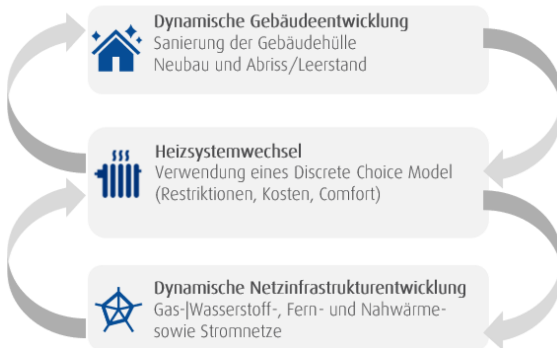
Abbildung 37: Funktionsweise des Simulationsalgorithmus simergy.
