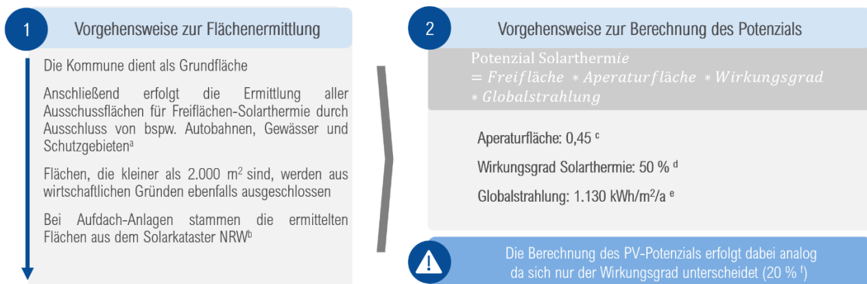
Abbildung 22: Vorgehensweise zur Ermittlung von Solarpotenzialen.
